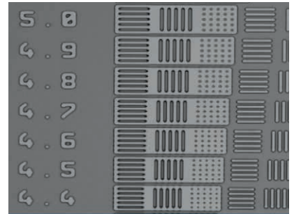
EVG® IQ Aligner NT® (REO仕様)で 1μm 厚レジストに露光 (プロキシミティギャップ 30μm)した解像度 5μm 以下のパターン 提供:EVG
